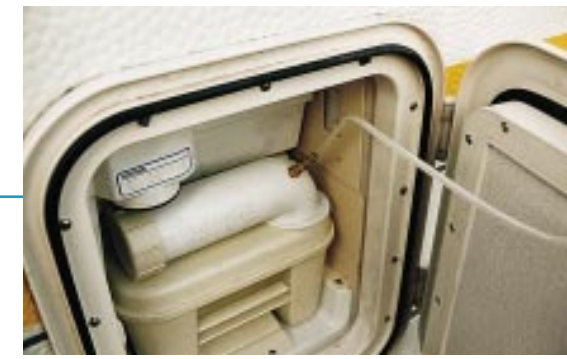
Selbsttätiger Luftaustausch: Beim Nokem-System strömt Abluft aus der Cassette durch ein außen angebrachtes Labyrinthgehäuse mit vorgeschaltetem Aktivkohlefilter.
