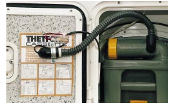
Elektrischer Lüfter: Die Sog-Toilettenentlüftung erzeugt Unterdruck, der Mief strömt nach draußen.
