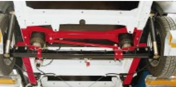
Geprüft: Voll-Luftfederung von Kuhn für die Euro-chassis.
