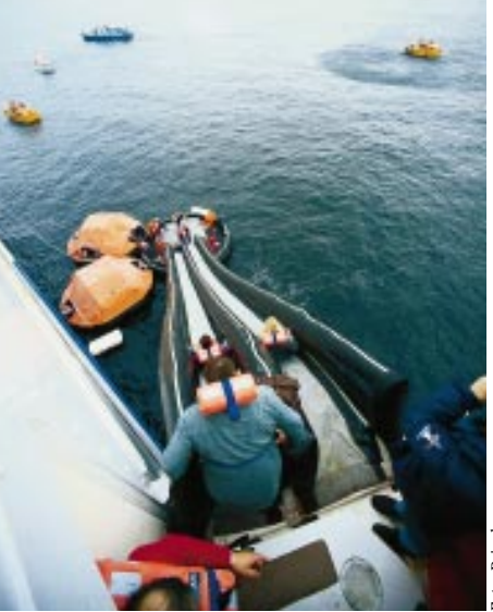
Rutschbahn: Um im Notfall möglichst schnell reagieren zu können, hat die DFO auf der „Sassnitz“ aufblasbare Rutschen installiert.
