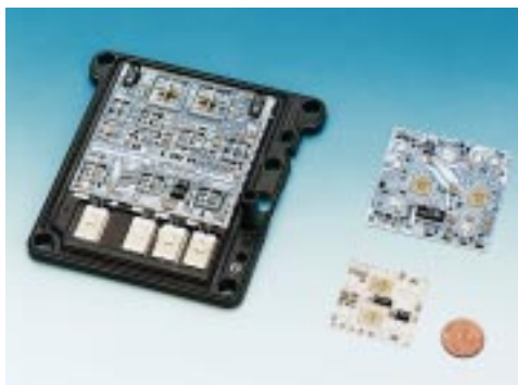
Miniaturen: Durch Fortschritte in der Elektronik-Entwicklung werden die ABS-Bauteile immer kleiner.
