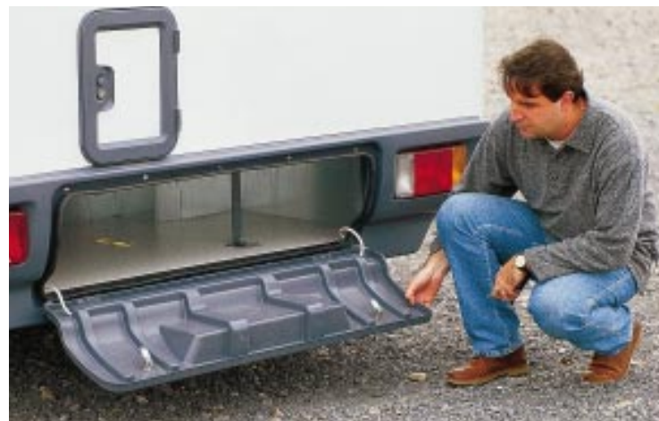
Tieflader: Hinter der abgeklappten Heckschürze verbirgt sich ein flacher Stauraum.
