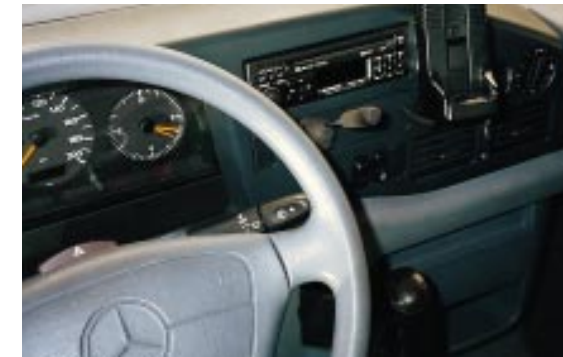
Geschaltet: Der Retarder wird mit einem Kipp-schalter rechts vom Lenkrad (im Bild: Kloft) oder über das Bremspedal betätigt.
