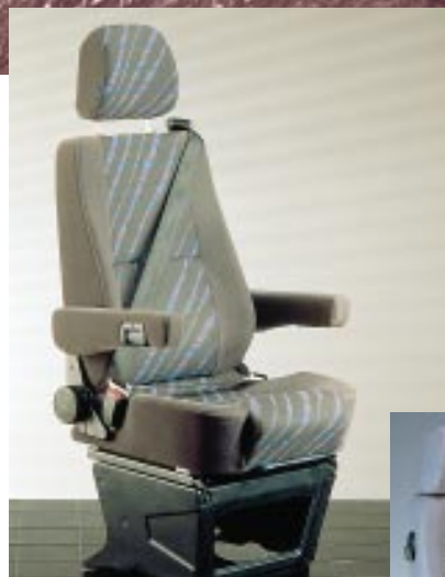
Integriert: Der Sportcraft S7 zeigt sich mit integriertem Dreipunkt-Sicherheitsgurt, zwei Armlehnen und verstellbarer Kopfstütze (oben).
