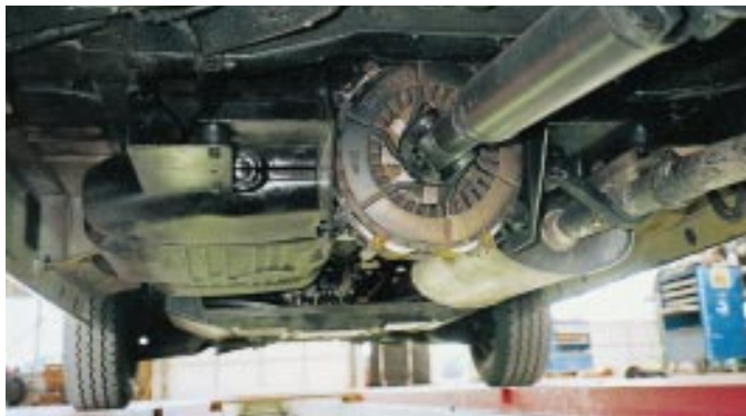
Montiert: Einbaubeispiel eines Kloft-Retarders im Sprinter-Kastenwagen.
