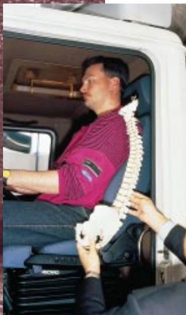
Gestützt: Orthopädisch richtige Sitze (rechts außen) zeichnen sich dadurch aus, daß sie den gefährlichen Rundrücken (links) ver- hindern.
