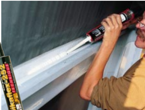
Geklebt: Das Hochdach wird mit Sikaflex 252 mit dem vorher angeschliffenen Kastenwagen-Dachrand verklebt.
