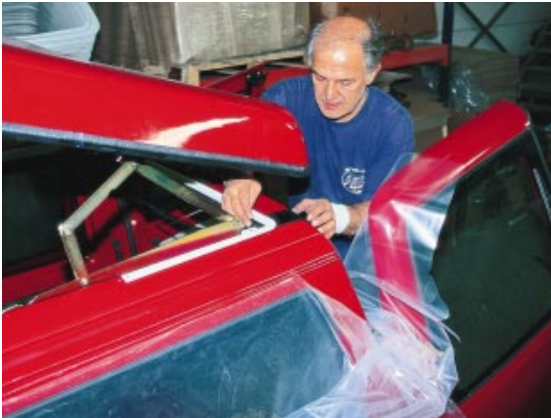
Geklebt: Das Hochdach wird mit Sikaflex 252 mit dem vorher angeschliffenen Kastenwagen-Dachrand verklebt.
