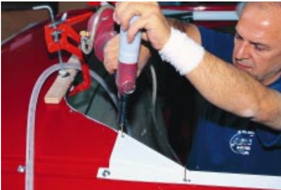
Gebohrt: Die Aufnahmen für das Aufstelldach werden vor dem Nieten oder Verschrauben vorgebohrt.
