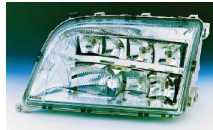
Erforscht: Scheinwerfer mit variabler Lichtverteilung in Freiflächentechnik.
