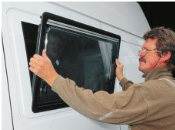
Gezeichnet: Mittels Schablone legt man den Fensterausschnitt fest (oben), vor dem Bearbeiten probiert man dessen Passungen (links).
