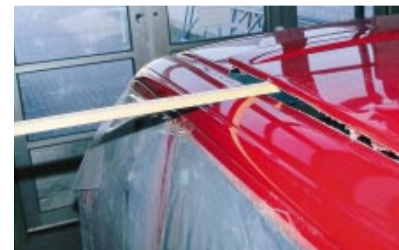
Geklemmt: Ein untergelegtes Brett hindert den Dachausschnitt am Hinunterfallen.
