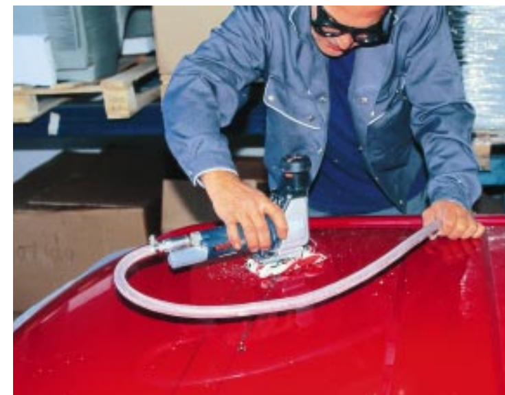
Gesägt: Rundum wird der Ausschnitt mit der Stichsäge herausgetrennt.
