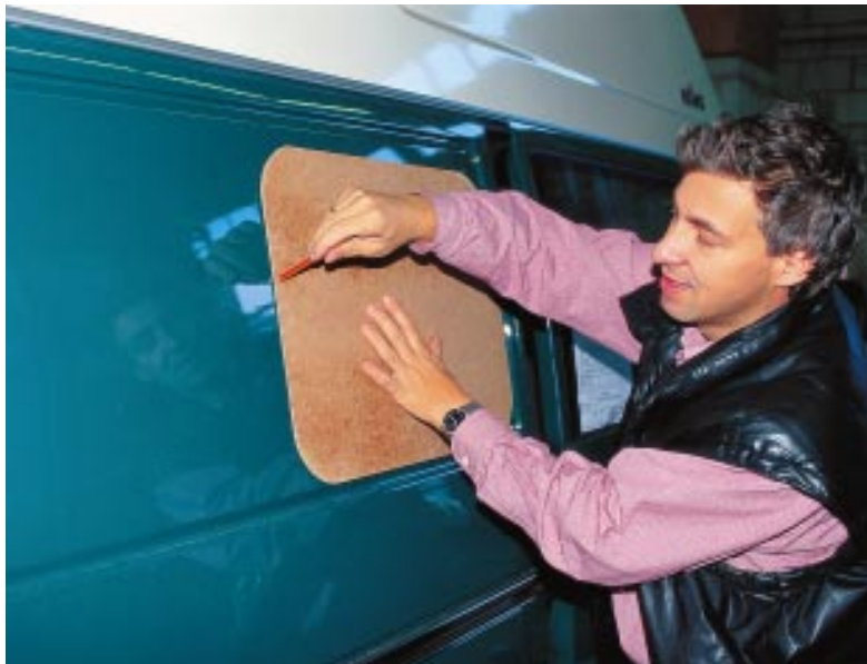
Gezeichnet: Mittels Schablone legt man den Fensterausschnitt fest (oben), vor dem Bearbeiten probiert man dessen Passungen (links).
