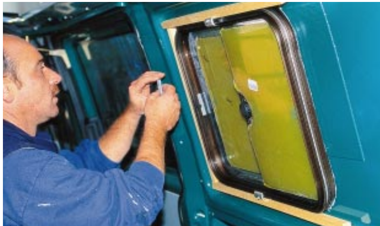
Geklemmt: TB-Fenster werden mit Klammern am Innenrahmen befestigt.
