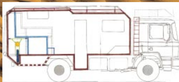
Draufblick: Raddatz hat sein Mobil um Heckgarage und Durchstieg geplant.
