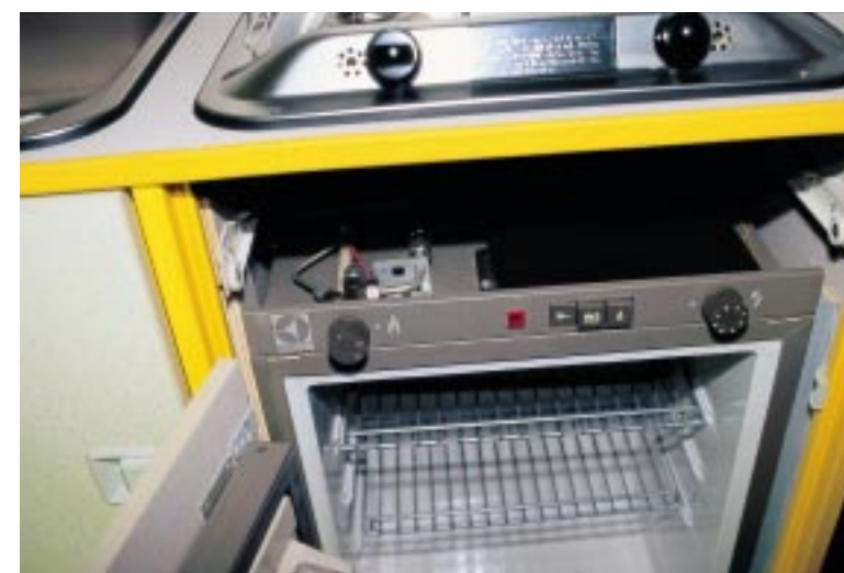
Gekühlt: Verschraubung der Gasleitung am Absorber- kühlschrank.
