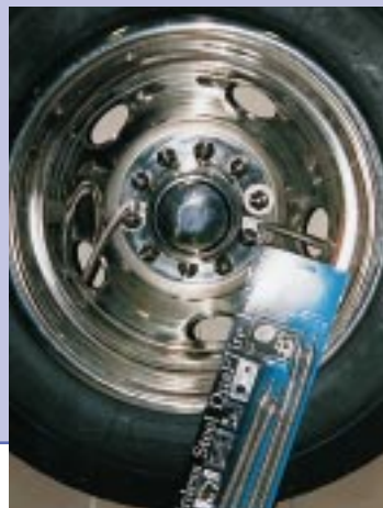
Luftdruckprüfen leicht gemacht: mit dem Ventilverlängerungssatz von Winnebago.
