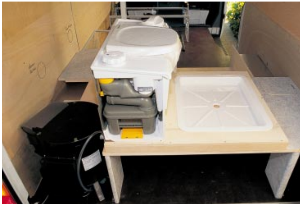
Gebaut: Sockel auf doppeltem Boden für Duschtasse und Cassetten-toilette.
