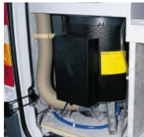
Gefunden: Platz für den Boiler im Fahrzeugheck (unten).
