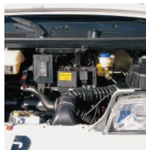
Mittig: Über dem Motor sitzt die nachträglich montierte, für den Flüssiggasbetrieb des Ducato zuständige Elektronik.
