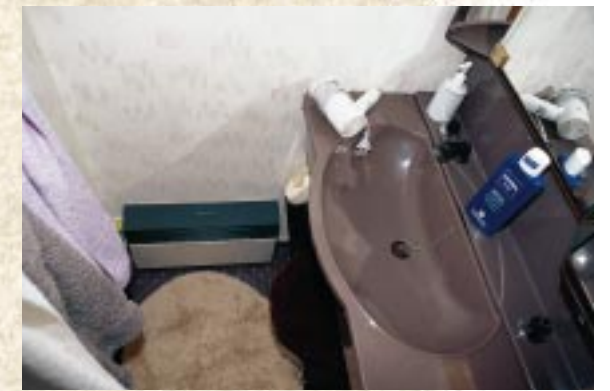
Waschplatz: Unter dem Klappwaschbecken versteckt sich die Toilette mit Häckselwerk und separatem Fäkalientank.
