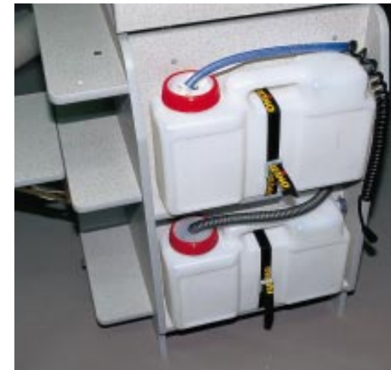
Geringer Platzbedarf von Frisch- und Abwassertank im Küchenteil (links). Frischwasser-einfüllstutzen (unten).
