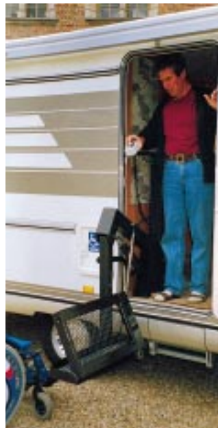
Gesenkt: faltbarer Lift HBC 200 Evasion (links),
