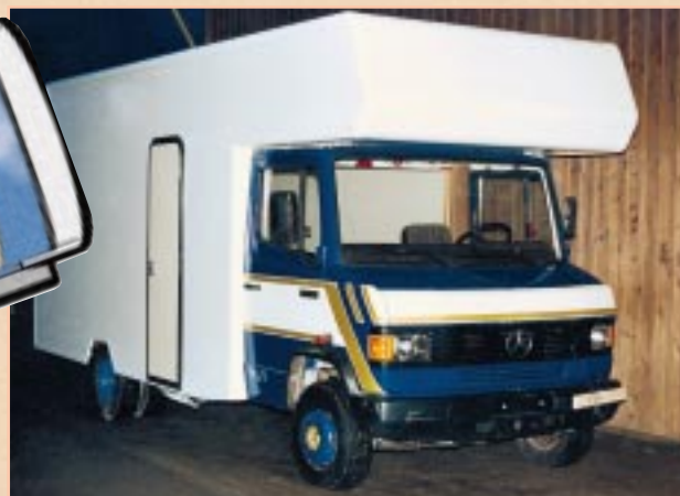
Geklebt: Den Wohnwagenaufbau haben die Trittners direkt auf dem Chassis zusammengefügt.
