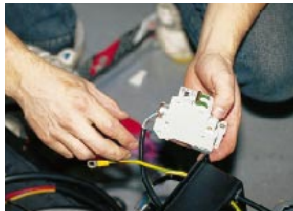
Gesichert: FI-Automat zum Personenschutz (links) und D-Leitung für das Signal der Lichtmaschine (oben).
