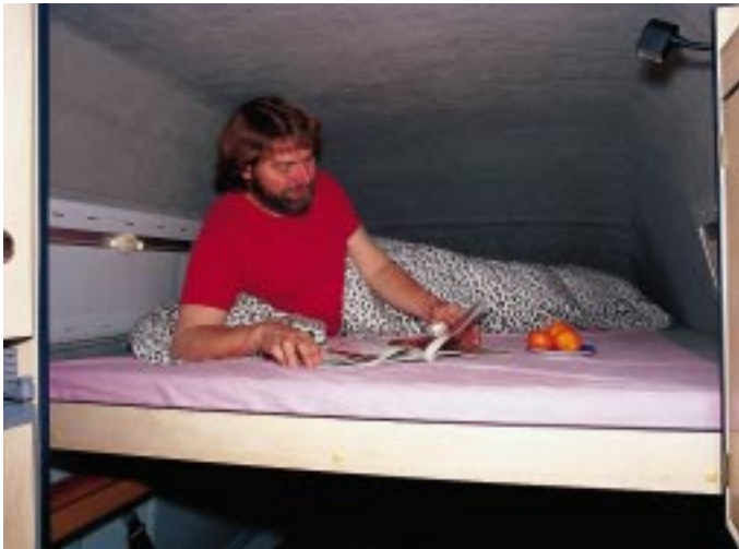
Abgesenkt: Das Dachbett mit Lattenrost und einteiliger Matratze läßt sich mit einem Griff herunterziehen.
