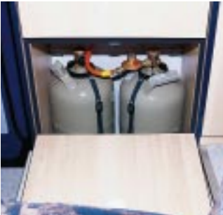
Verzurt: Zwei Fünfkilo-Gasflaschen sitzen unten im Küchenblock.
