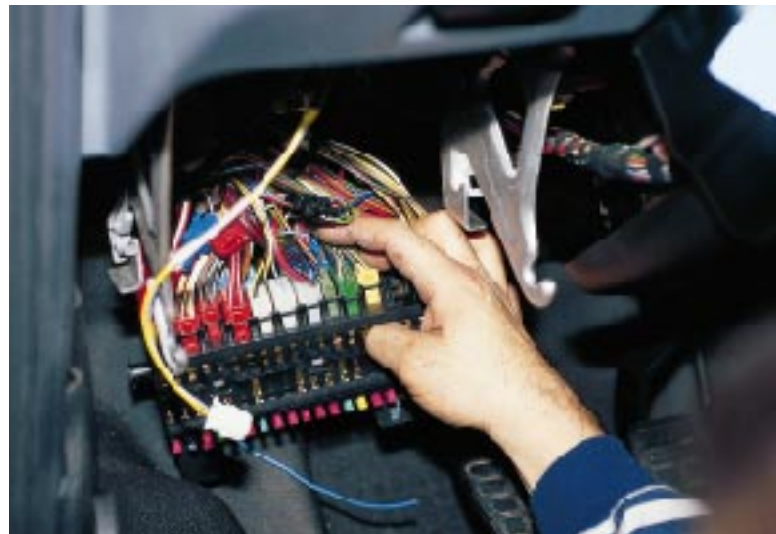
Gesichert: FI-Automat zum Personenschutz (links) und D-Leitung für das Signal der Lichtmaschine (oben).
