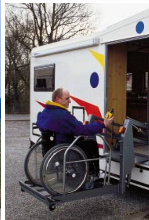
Auffahrhilfe: Der elektrisch absenkbare Rollstuhl-lift schafft bis zu 350 Kilogramm.
