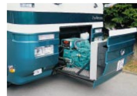
Praktisch: Das Heizkraftwerk erreicht man über eine Seitenklappe (unten).
