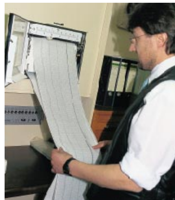
Der Datensreiber informiert während der Testreihe ständig über die Temperaturen.
