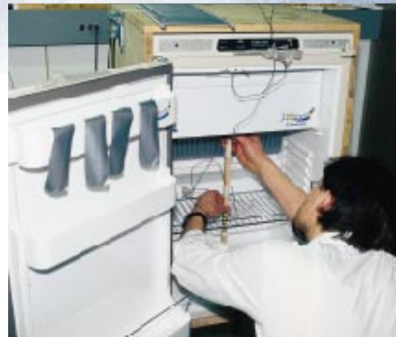
Der Meßfühler für die Temperatur des Kühlfachs wird genau mittig plaziert.
