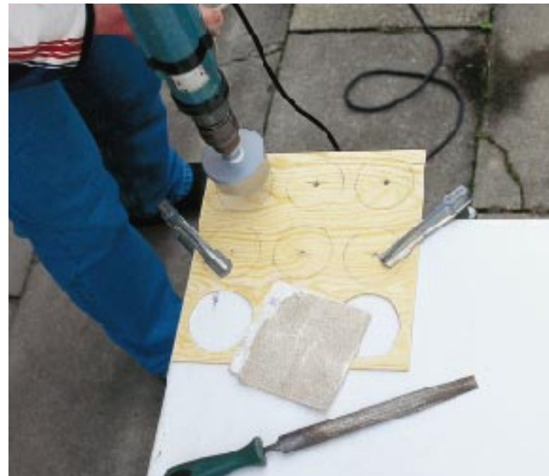
Gesägt: Die Lochkreissäge schneidet Öffnungen für Tassen oder Gläser heraus.
