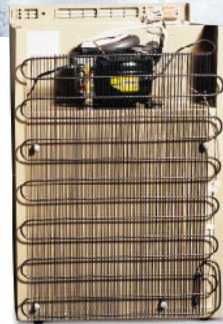
Waeco-Kühlschrank von hinten, gut sichtbar der Danfoss-BD-Kompressor.
