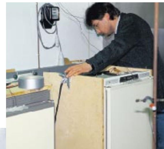
Genaueres Einpassen der Testgeräte in Holzkisten, um den Einbau im Reisemobil zu simulieren.
