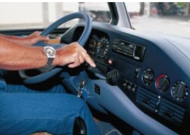
Gebremst: Mit dem Hebel rechts vom Lenkrad wird der dreistufige Retarder aktiviert.
