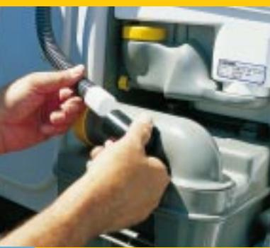
**9** Steckverbindung der Abluftleitung mit etwas Spülì als Gleitmittel für das spätere Lösen einreiben und zusammen-stecken.
