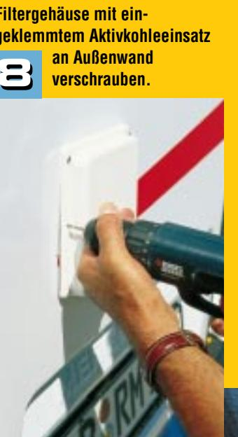
**8** Filtergehäuse mit eingeklemmtem Aktivkohleinsatz an Außenwand verschrauben.
