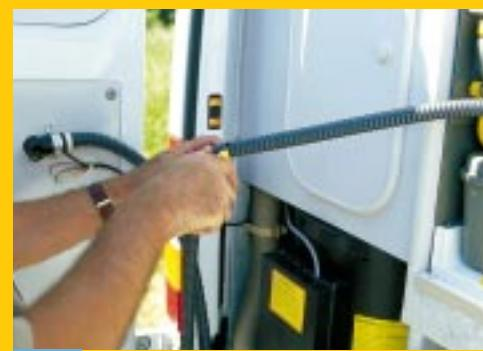
**6** Einzelteile der Abluftleitung so ablängen, verschrauben und zusammenstecken, daß sie auch bei geschlossener Tür stetig fallen, aber nicht durchhängen.
