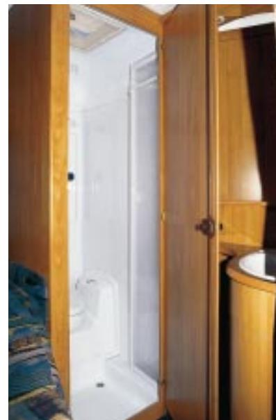
**Duschkabine:** Mit drehbarer Cassettentoilette und Duschtasse ist das Bad des Tramp ausgestattet.
