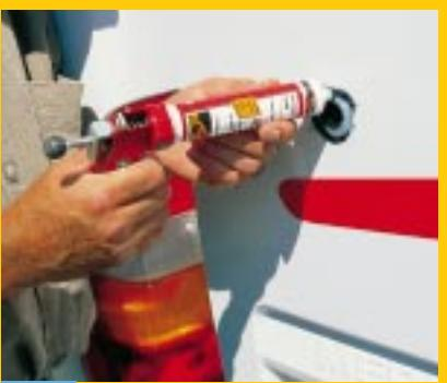
**7** Durchführung des Austritt-stutzens der Abluftleitung durch die Karosserie mit Silikon ab-dichten, um Gaseintritt zu vermeiden.
