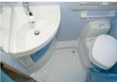
Kompakt: die Naßzellen mit drehbaren Cassetten-Toiletten.
