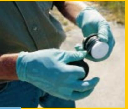
**2** Überdruckventil der Fäkal-tanks neuerer Bauart (oliv) herausdrehen und durch festes Umwickeln mit Isolierband außer Funktion setzen.
