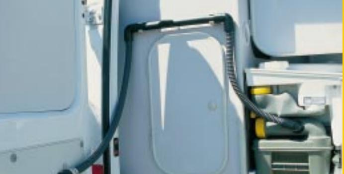
**10** Fertig: Die funktionsfähige Anlage mit über die Schrankklappe gezogener und durch die linke Hecktür nach außen verlegter Abluftleitung.
