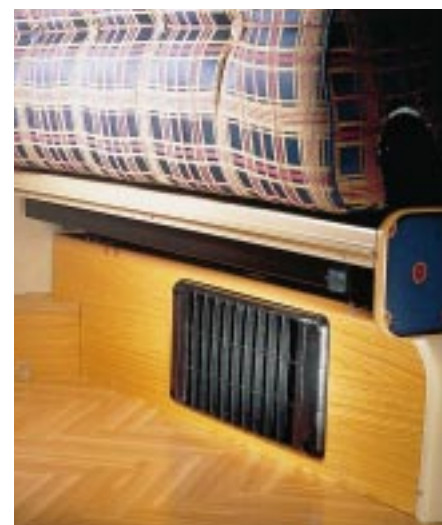
Geheizt: Ein Ausströmer der Motorheizung erwärmt den Laika-Wohnraum.
