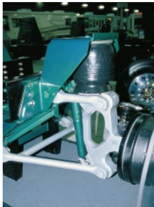
Konstruiert: Neue, luft-gefedernde Vorderachse des Freightliner-Reisemobil-Chassis.
