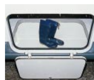
Schmutzfänger: Die Bodenwanne des Außenstauraums besteht aus Kunststoff.
