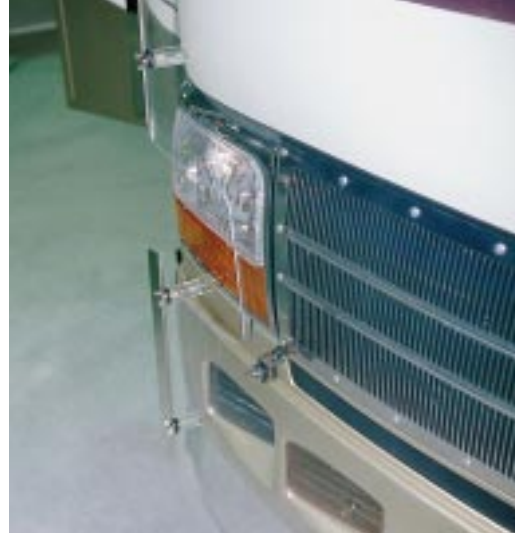
Vorgesetzt: Die Frontpartie einiger US-Integrierter schützt eine durchsichtige Plexiglas-scheibe.
