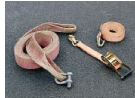
Gezurrt: Leichte Fahrzeuge lassen sich mit einem Zurrgurt aus dem Matsch herausziehen.
