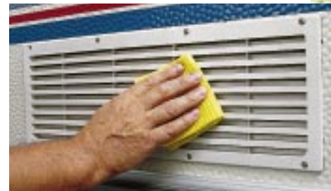
Kühlschrankschrankgitter setzen sich gern mit Schmutz zu, der dann die Funktion stören kann.
