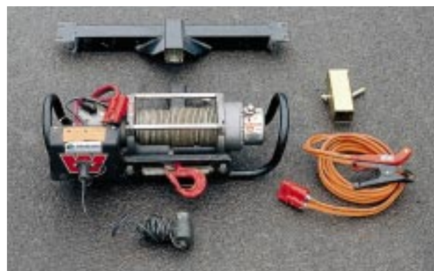
Gezogen: Die kompakte Warn-Seilwinde läßt sich dank langer Elektrokabel und Fernbedienungsleitung universell zum Bergen einsetzen.
