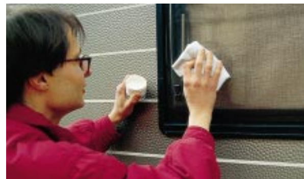
Gummidichtungen brauchen viel Pflege. Sind sie kaputt, drohen schwere Schäden durch Feuchtigkeitseinbruch.
