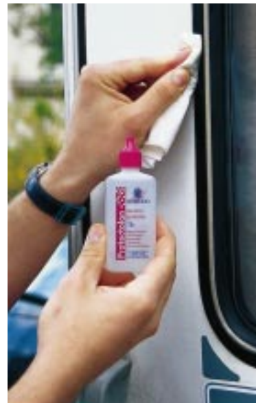
Gummidichtungen brauchen viel Pflege. Sind sie kaputt, drohen schwere Schäden durch Feuchtigkeitseinbruch.
