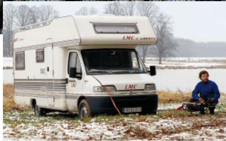
Verkabelt: Die Winde bezieht ihren Strom direkt von der Fahrzeugbatterie, die vorn rechts im Ducato-Motorraum sitzt.
