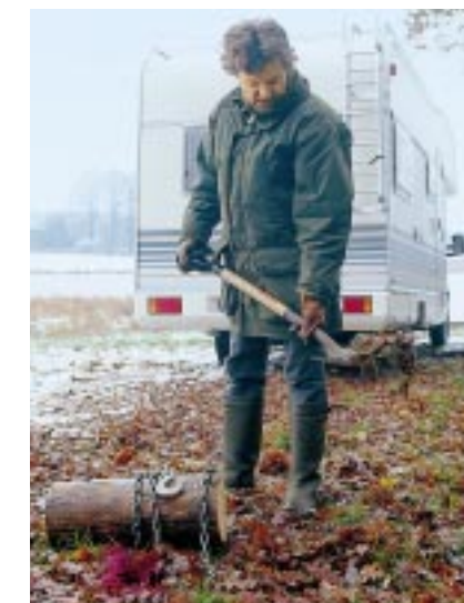
Gegraben: Als Widerlager kann ein ausreichend tief eingegrabener Baumstumpf dienen.
