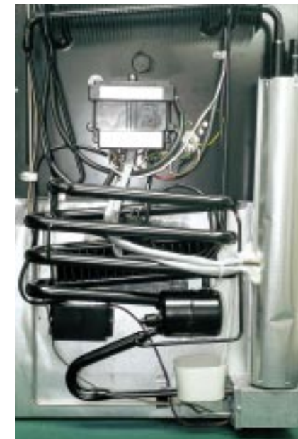
Geordnetes Chaos: So sehen die einzelnen Bauteile eines Electrolux-Absorbers aus.
