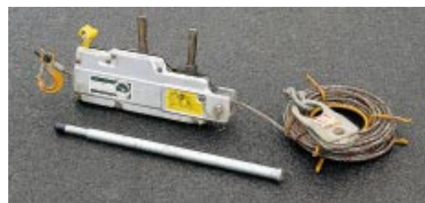
Gehebelt: Das Zugseil wird durch den Greifzug geführt.
