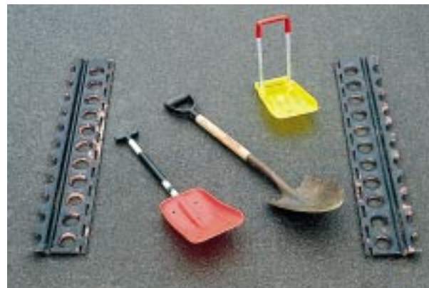
Weggeräumt: Mit Schaufeln und Sandblechen verringert man den Widerstand vor den Rädern.
