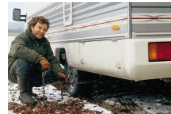
Gezurrt: Zum Rückwärts-herausziehen schlingt Lapp eine Kette um die Hinterachse.
