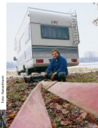
Gegurtet: Dient ein Baum als Gegenlager, umwickelt man ihn zur Schonung mit einem Bergegurt.
