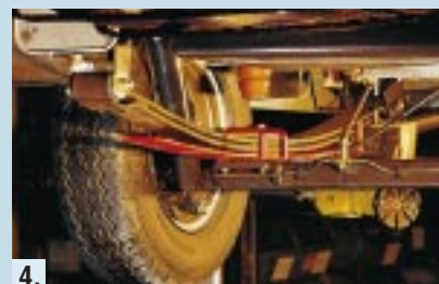
4. Die Blattfeder sitzt fertig montiert unter der Serienfeder.
