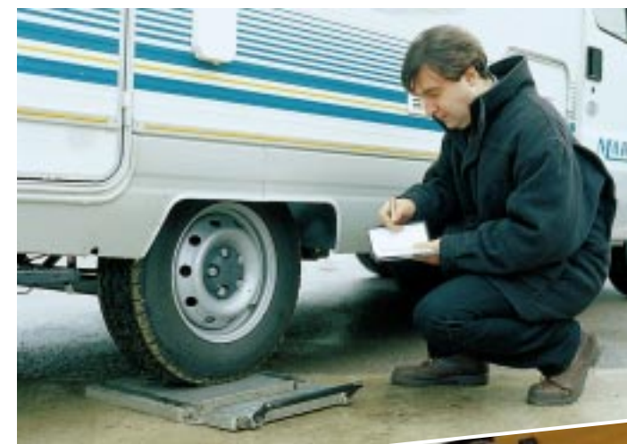
Vorbereitungsphase: Vor den Testfahrten werden die Hinterachslasten ermittelt.
