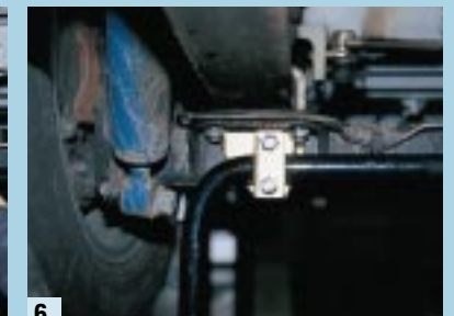
6. Der Stabilisator wird an der Lagerbuchse festgemacht.
