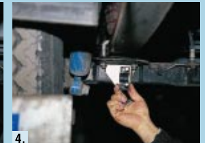
4. Die Lagerbuchsen werden an der Haltevorrichtung angebracht.
