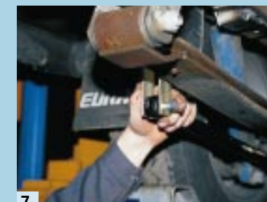
7. Der hintere Teil des Stabilisators wird am Hängeeisen befestigt.
