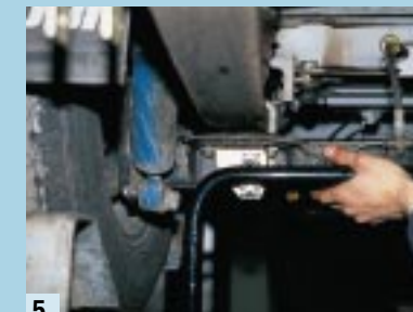
5. Der Stabilisator wird in die Lagerbuchse eingepaßt.
