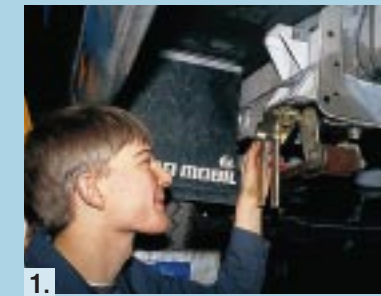
1. Die Hängeeisen werden an den Fahrzeugrahmen montiert.
