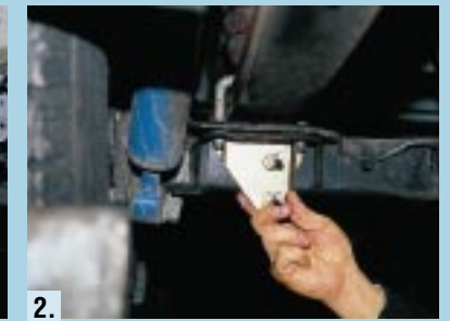
2. Die Haltevorrichtung für die Lagerbuchse wird an die Hinterachse angepaßt.
