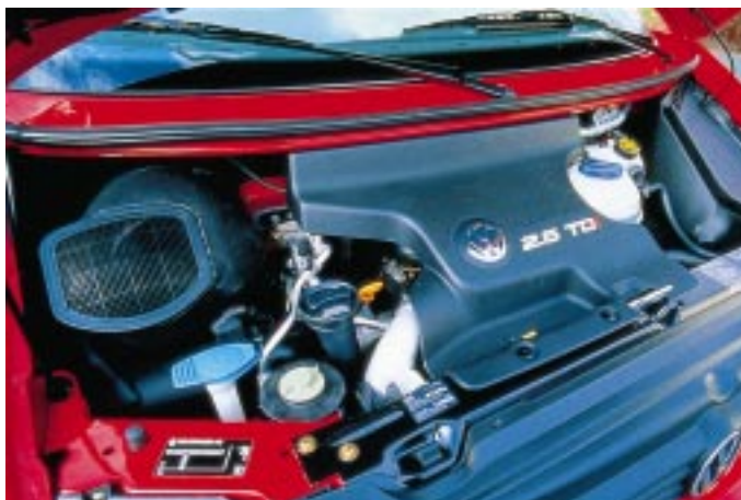
Aufgeräumt: Der Ladeluftkühler des 111 kW (150 PS)-Motors sitzt vor dem Kühler.
