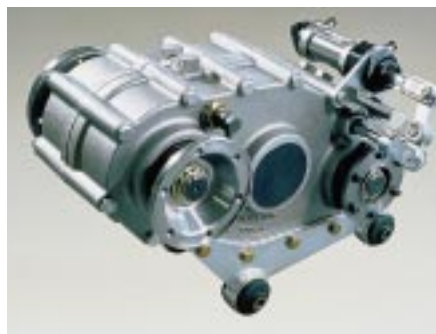
Prinzipien: Das kompakte Verteilergetriebe des Sprinter (links), Allrad-Konzept des Vario (unten).
