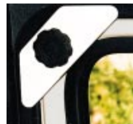
Mechanik: Schraub-Sicherung für die Fahrerhaustüren von Luther.
