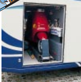
Tiefklader: Im doppelten Boden sitzen zwei Heckgaragen.
