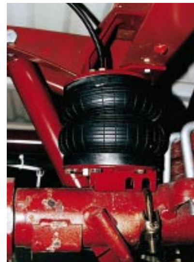
Luftsäcke: Kuhns Zusatzluftfedern für Daily, Master und Movano.
