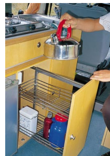
Wohin mit Töpfen und Geschirr? Unter dem zwei-flammigen Kocher befindet sich ein Drahtauszug.
