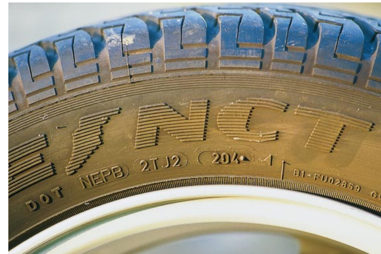
Erkannt: Die DOT-Nummer weist auf das Herstellungsdatum hin. 204 und das Dreieck bedeuten: 20. Woche 1994.
