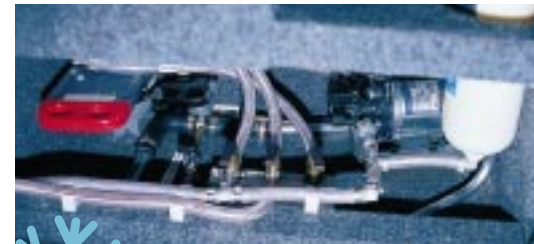
Gebunkert: Der ideale Platz für Tanks, Wasserpumpen und Ablaßventile oder -schieber sind doppelte Böden (oben: Frankia, unten: Variomobil).
