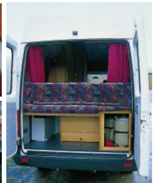
Praktisch: Der Heckstauraum und der Gasflaschenkasten sind über die Hecktüren erreichbar (oben), der Frischwassertank sitzt hinter den Frontsitzen.
