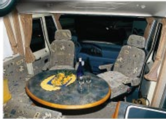
Gedreht: Fahrer- und Beifahrersitz ergänzen die Längscouch zur Rundsitzgruppe.
