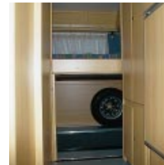
Geöffnet: Die Heckgarage ist durch eine Schiebeklappe auch von innen zugänglich.
