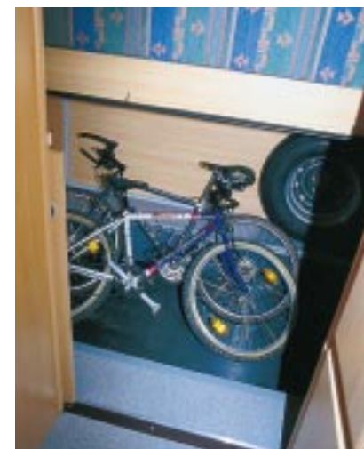
Weggeschoben: Die Heckgarage ist unter dem zusammen-schiebbaren Bett durch eine Schiebetür von innen zugänglich.
