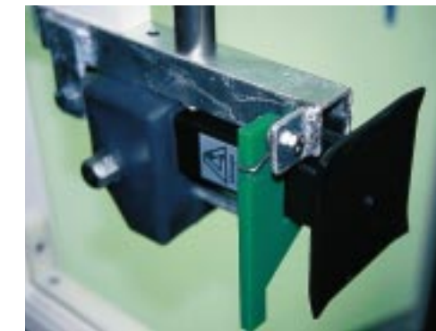
Eingeschnappt: Ein Keil soll Bedienkomfort an der Quick-Lift-Stütze von Linnepe sichern.
