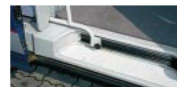
Sicher: Die verschiebbare Sitzbank läßt sich arretieren.
