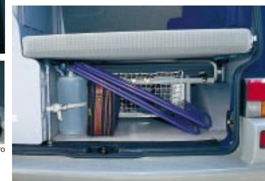
Praxisgerecht: Im Heck sitzen Kofferraum, Frischwasserkanister und Gasflaschenkasten.
