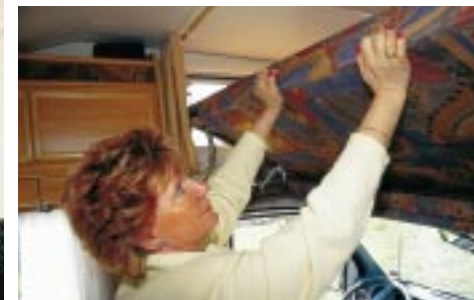
Aufgeklappt: Für den bequemeren Durchstieg nach vorn läßt sich ein Teil des Alkovenbettes nach oben klappen.
