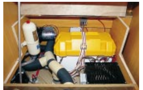
Aufgeräumt: Unter den Trittstufen vor dem Bett sind die Elektrik und die Wasserpumpe geschickt untergebracht.
