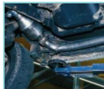
Um die Klammern zu entfernen und später wieder einzusetzen, sind spezielle Spannkeile nötig – das einzige Spezialwerkzeug für die Oxi-Kat-Montage am Fünfzylinder. Am Ende des neuen Flammrohrs ist der Katalysator angeflanscht und die Verbindung zur verbleibenden Abgasanlage schafft ein neues Stück Abgasrohr, rostfrei wie alle stählerne Komponenten der Oberland-Anlage. Ist der Katalysator mit dem Flammrohr und der hinteren Abgasanlage verbunden, geht es mit den Arbeiten im Motorraum weiter.
