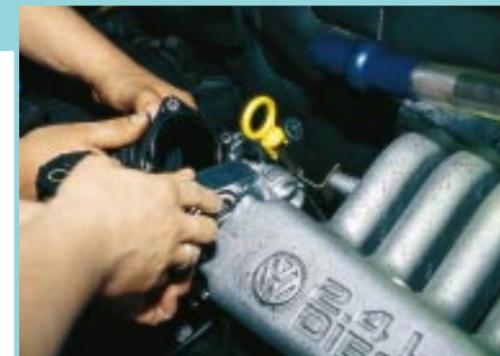
Einbau: Einspritzpumpe mit aufgesetztem Microschalter (links) und Lufteinlass mit Zwischenflansch für die Abgasrückführung.
