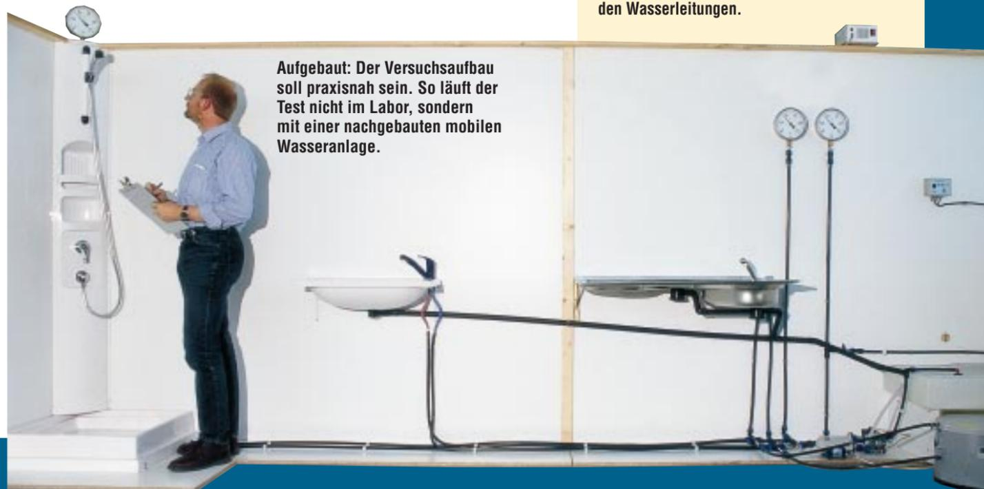
**Aufgebaut: Der Versuchsaufbau soll praxisnah sein. So läuft der Test nicht im Labor, sondern mit einer nachgebauten mobilen Wasseranlage.**
