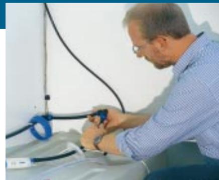
**Angeschlossen: Ist die Pumpen am Netz, registrieren Messgeräte Druck, Spannung und Stromaufnahme.**
