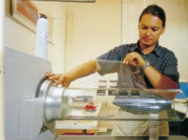
**Technik bedienen:** Die Daten jedes Dias, das in REISEMOBIL INTERNATIONAL gedruckt wird, nimmt ein Trommelscanner auf. Holger Koch weiß das hochkomplexe Gerät einzusetzen – und die Bilder anschließend weiterzubearbeiten.
