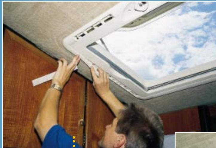
**10** Nach dem Verschrauben klinken wir ringsum die Lüftungsgitter ein.
