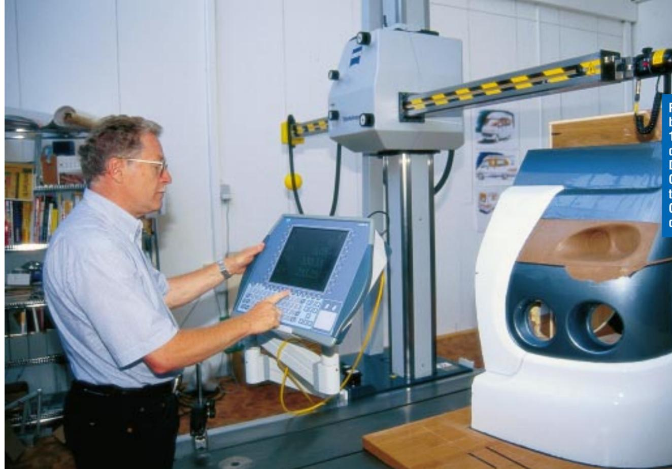
**Präzisionsarbeit:** Von einem 1:1-Modell werden die exakten Daten auf einen Computer übertragen – als Grundlage für die Werkzeuge.
