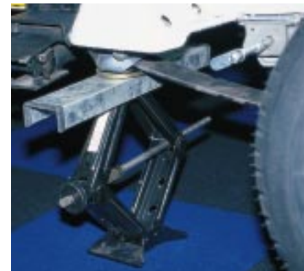
Aufgebockt: Scherenhubstützen von Kuhn machen den Wagenheber überflüssig.
