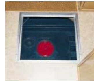
Das Servicefach für die Wassertanks im Fahrzeugboden.
