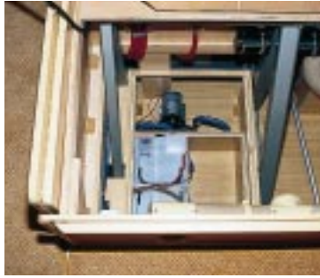
Das Extrafach für Druckwasserpumpe und Bordbatterie.
