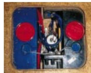
im doppelten Boden vor dem Eingang integriertes zusätzliches Schuhfach mit frostsicher installiertem Ablasshahn für den Abwasserbehälter ebenso gehört wie das Servicefach im Boden für die ebenfalls frostsicher im Doppelboden untergebrachten Versorgungstanks.
