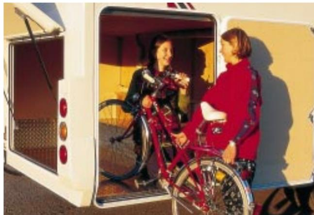
**Geöffnet: Die Heckgarage bietet Platz in Hülle und Fülle. Die Heckklappe wird von einem Gasdruck-Stoßdämpfer gehalten.**
