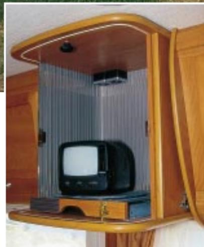
**Absenkar:** Das Fernsehfach ist voll verkabelt, mit Befestigungsplatte und Lamellenschieber ausgestattet und tieferzulegen.
