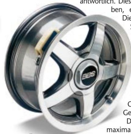
**Überwacht: Smart Tire warnt bei falschem Luftdruck.**
