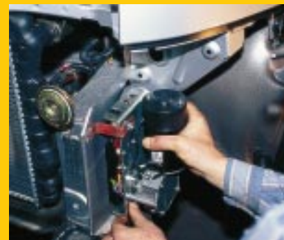
1 Montage des Elektromotors, der per Bowdenzug die Kupplung betätigt. Dieser soll später möglichst gerade verlaufen.
