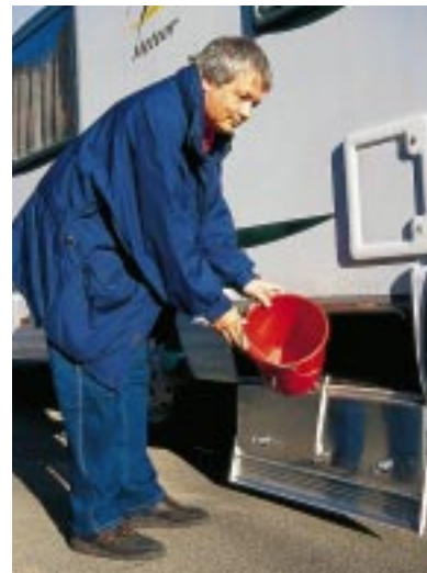
Platzsparer: Der Einfüllstutzen für Frischwasser sitzt im Gasflaschen-Kasten. Die Außenstauräume haben eine viel zu schmale Öffnung.
