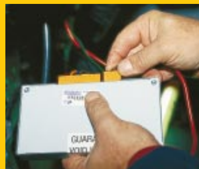
8 Die Steuereinheit nimmt die Steckerleisten auf. Sie verschwindet später hinter dem Armaturenbrett.
