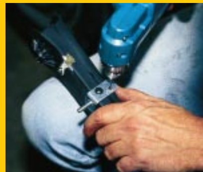
3 Ein Winkel, auf das Kupplungspedal geschraubt, nimmt den Bowdenzug auf.
