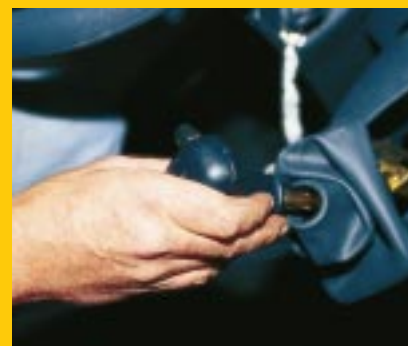
7 Der aufgerüstete Schaltknopf kommt an seinen Platz zurück, die Kabel verlaufen zur Steuereinheit.
