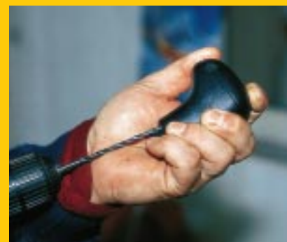
6 Mit Fingerspitzengefühl und Bohrmaschine erhält der Schaltknopf einen Kanal für Kabel und Schalter.
