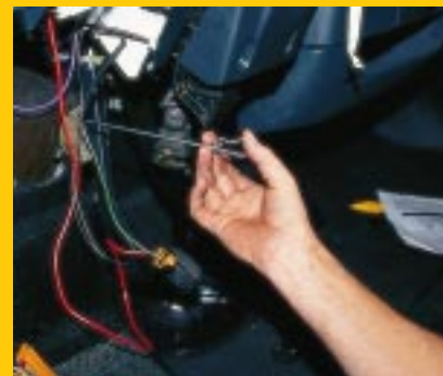
2 Der Bowdenzug muss in einem bestimmten Winkel in den Fußraum münden, damit die Zugrichtung am Kupplungspedal stimmt.
