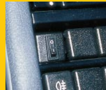
5 Der kleine Hauptschalter findet im Armaturenbrett problemlos Platz. Hier kann der Fahrer wählen, ob er per Fuß oder auf Knopfdruck kuppeln möchte.
