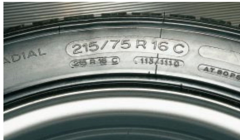
Aufgeprägt: Die Zahlen auf der Reifenflanke zeigen alle wichtigen Daten. Die DOT-Nummer (ganz rechts) gibt das Reifenalter an.
