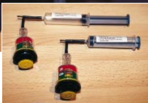
Sichtbar: Nach Art einer Spritze arbeitet die Anzeige für den Luftfilter-Zustand.
