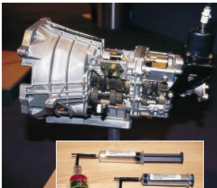
Aufgeschnitten: Das Modell zeigt das Innenleben des Fünfgang-Getriebes.
