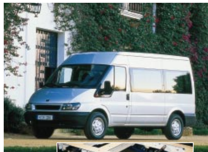
Verglast: Kombi-Variante mit bündig eingeklebten Scheiben.
