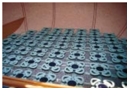
Zwischen dem Kunststoff-Lattenrostsystem im Alkoven verlaufen die Glysantin-Schläuche.
