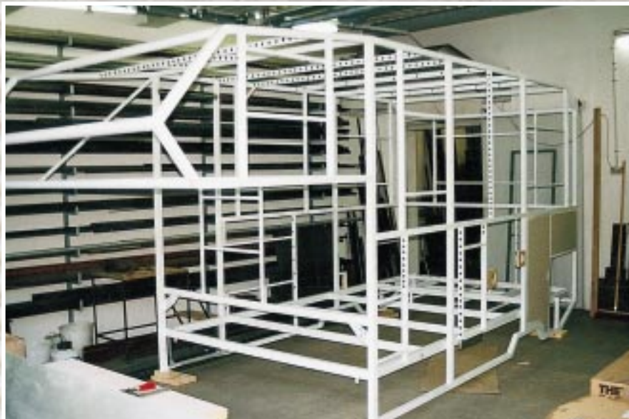
Geschweißt: Das Gerippe der Wohnkabine hat Ronald Penzel aus Vierkant-Stahlrohren gefertigt (oben).
