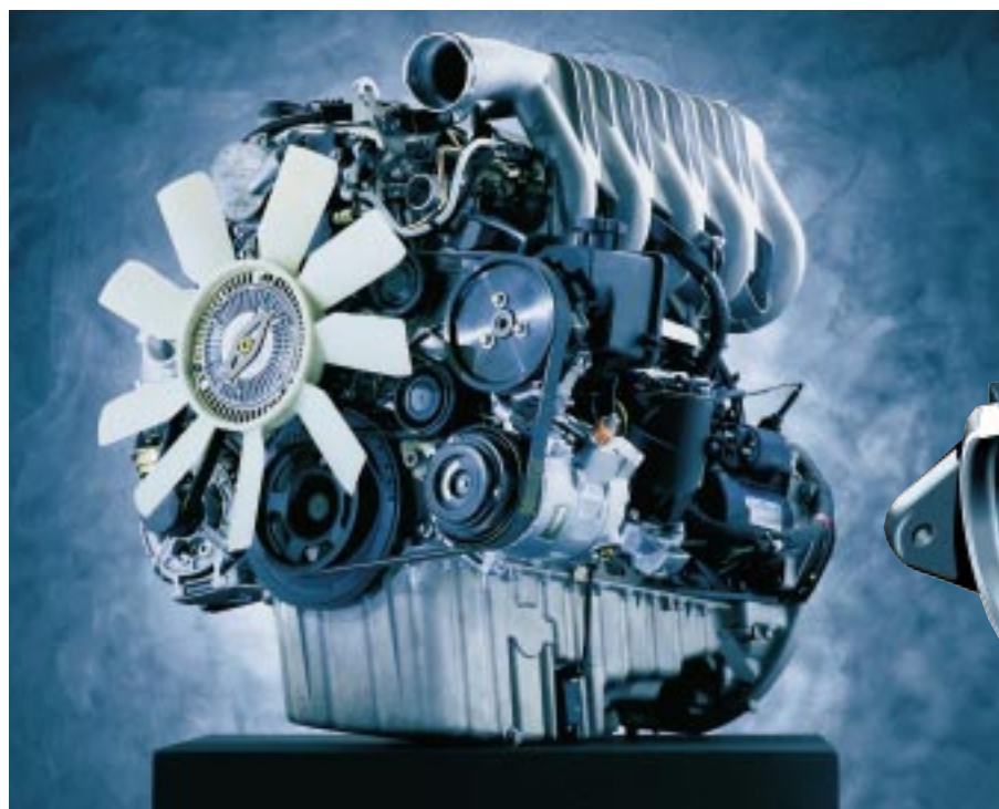
Kräftig: Die neuen CDI-Motoren (links das Fünfzylinder-Topmodell) haben Common-Rail-Direkteinspritzung, vier Ventile pro Zylinder, zwei obenliegende Nockenwellen und Turbolader mit verstellbaren Leitschaufeln (unten).
