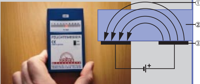
Messfeld: Das GM 41 misst über die Feldlinie (1) zwischen den Sensorplatten (3) den Feuchtegehalt im Material (2).
