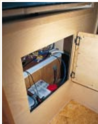
Wartungsfreundlich: die Bordbatterie im Unterschrank des Kleiderschranks.
