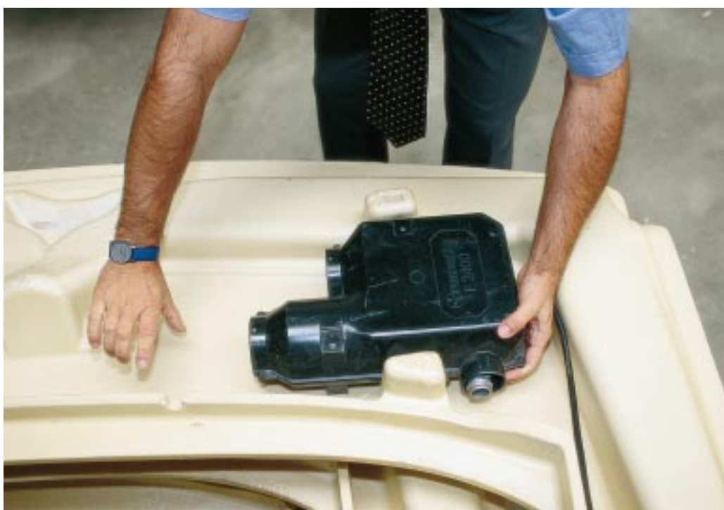
Musterbau: neues Hubbett (ganz oben) und Zusatzheizung unter der Armaturenbrett-Verlängerung.
