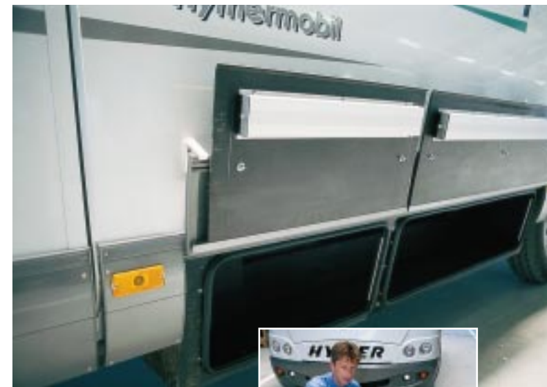
Eingeklebt: Neue Klappen (oben) verschließen die eingeklebten, seitlichen GfK-Staukästen (rechts).
