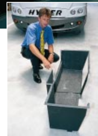
Eingeklebt: Neue Klappen (oben) verschließen die eingeklebten, seitlichen GfK-Staukästen (rechts).
