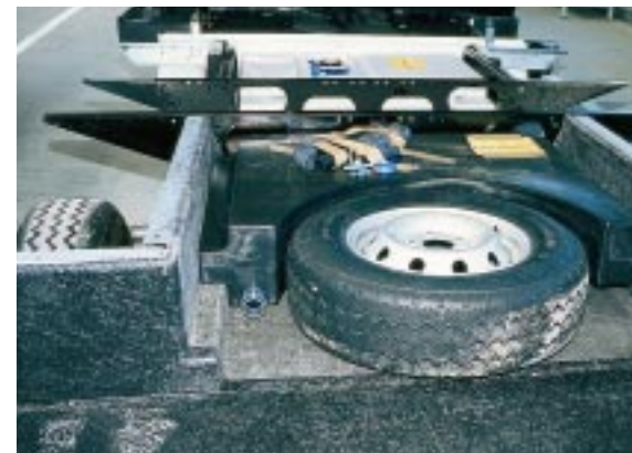
Aufgeteilt: Frischwassertank (rechts) und Abwasserreservoir liegen in Wannen zwischen den Rahmenlängs- und -querträgern.
