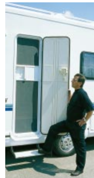
Praxisgerecht: Der Eingangsbereich ist mit Fliegengittertür und elektrisch ausfahrbarer Trittstufe ausgerüstet.
