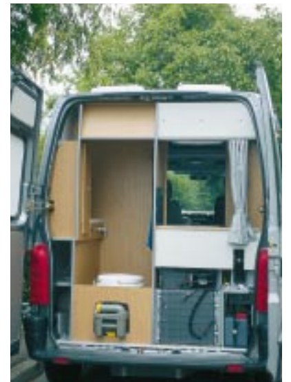
Geöffnet: Zugang zu Toilette, Aggregaten und Staufach (links).
