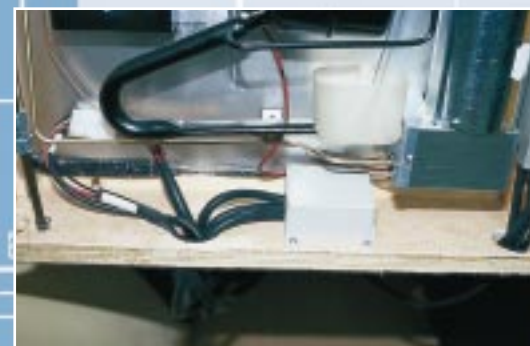
Unterbrochen: Die Zuleitungen zu den einzelnen Verbrauchern sind zur effizienteren Montage unterteilt und durch Stecker miteinander verbunden.
