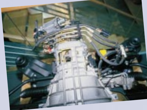
Ausladend: Das EST-Getriebe von Ford passt in die front- und heckgetriebenen Transit-Modelle.
