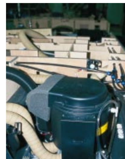
Abgesenkt: Links hinter der Hinterachse arbeitet die Truma-Boiler-Heizung C 6002.
