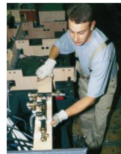
Eingelegt: Rechts hinten wird in der Hymer S-Klasse die Warmwasser-Heizung montiert.
