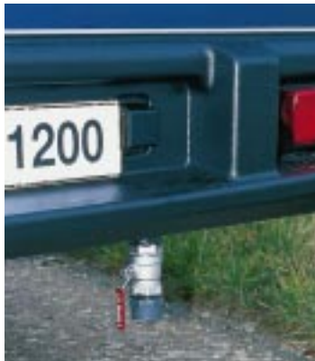
Der Abwasserschieber steht weit nach unten hervor. Die Gefahr, dass er abgerissen wird, ist deshalb groß.
