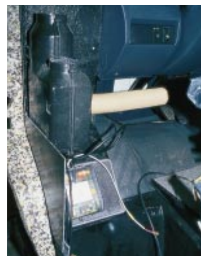
Seitlich: Die Truma E 2400 für das Fahrerhaus sitzt links unter dem Armaturenbrett.
