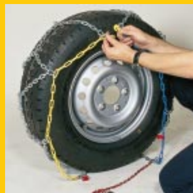
An äußerer Flanke des Reifens Kette mit Haken schließen.
