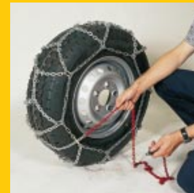
Nach einer viertel Drehung des Rades Bügel mit Spannkette zuziehen.
