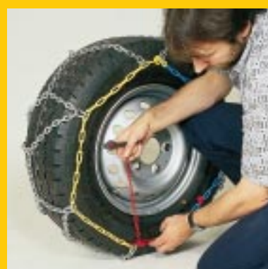
Spannkette durch Umlenkrolle führen und spannen.
