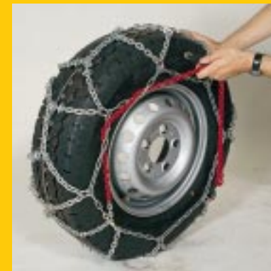
Durch die Spannkette wird die Schneekette gespannt.
