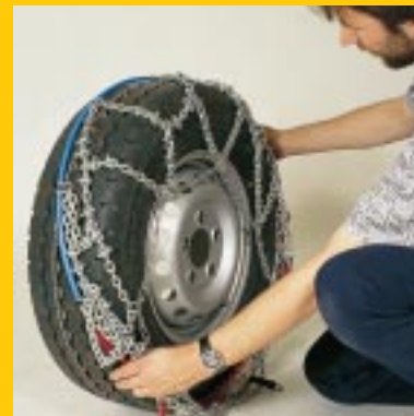
Federstahlbügel mit offenem Ende nach unten über den Reifen stülpen.
