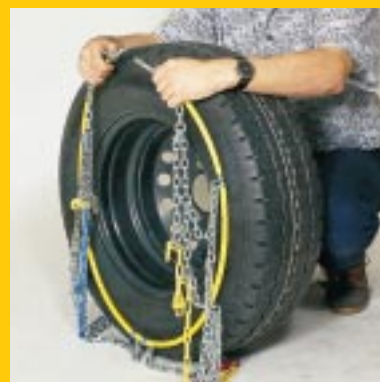
Federstahlbügel an der Innenseite des Reifens schließen.
