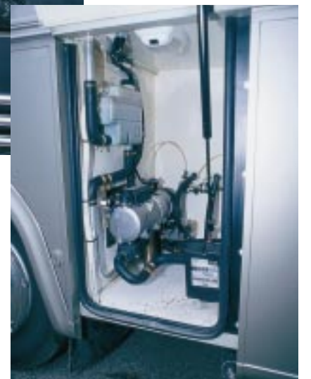
Warmwasser: Die Thermo 90 S des Rockwood (Grundriss nächste Seite) sitzt im Staufach hinter dem linken Vorderrad.
