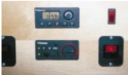
Bedienung: Thermoschalter und Zeitschaltuhr der Webasto-Heizung.
