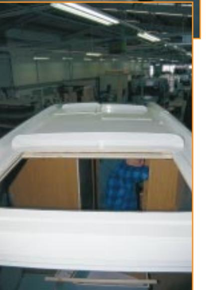
mit nahezu trocken, und gegen Spritzwasser schützen direkt vor den Hauben im Dach integrierte Spoiler. Nicht weniger aufwändig ist der Boden der Kabine: 5 Millimeter GfK, 32 Millimeter Hartschaum, 16 Millimeter Sperrholz, das Ganze miteinander verklebt und auch noch auf der Holzseite überlaminert.
