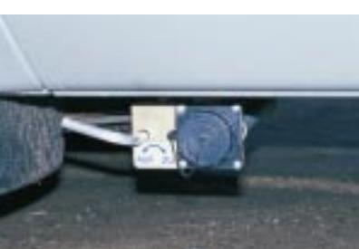
Die Bedienung des Hebels für den Abwasserschieber ist klar gekennzeichnet.
