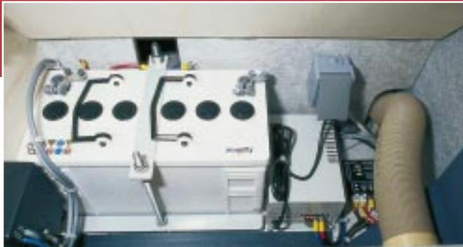
**Kraftwerk: Bordbatterie zwischen Ladegerät und Solarregler.**
