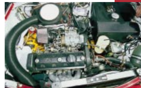
Kraft aus Wolfsburg: Unter der Plaste-Haube des Trabi werkelt ein Dieselmotor aus einem VW Polo.
