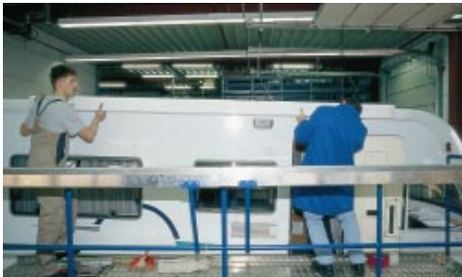
Bestens ausgestattet: Die mobile Arbeitsbühne erleichtert Arbeiten an der Seitenwand, etwa die Montage einer Markise.
