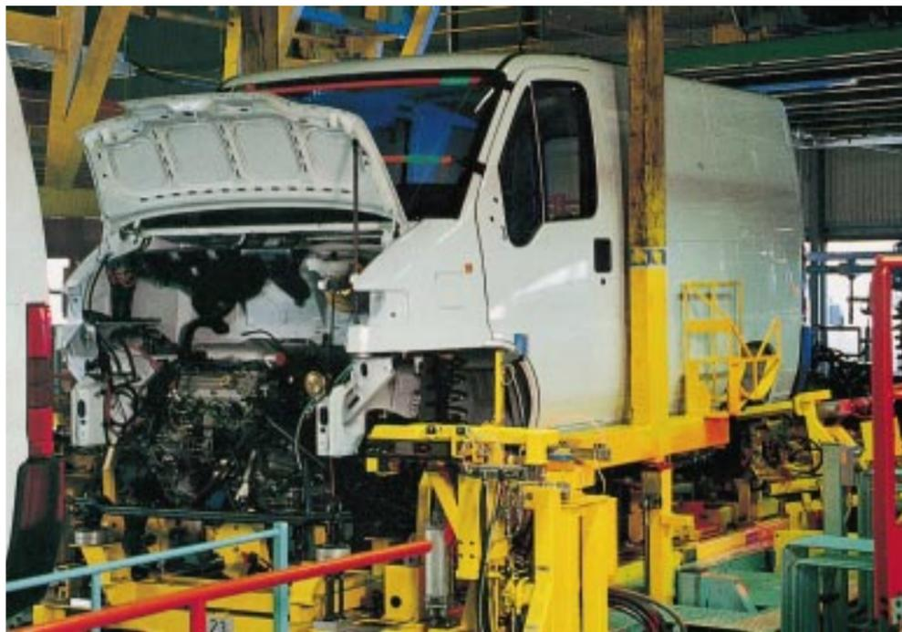
Einbau ab Juni: Im italienischen Werk bekommt der Fiat Ducato Motor und Automatikgetriebe, das ZF Friedrichshafen fertigt.
