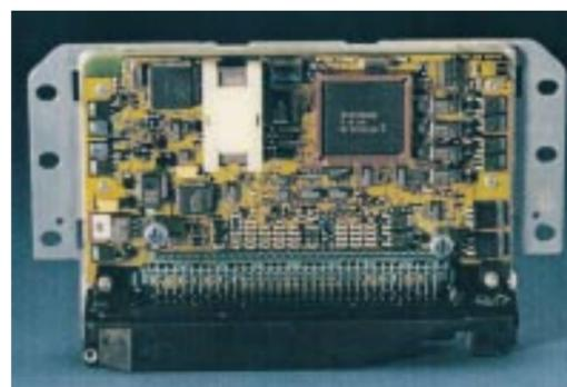
Schaltzentrale: Die elektronische Steuerung passt die Automatik der jeweiligen Fahrsituation an.
