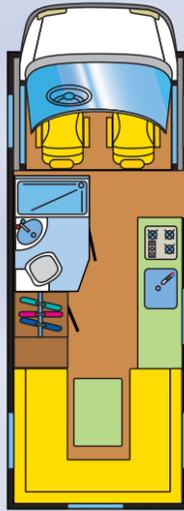
Der Eura A 635 HS besitzt einen doppelten Boden und eine Raumaufteilung, die sich aus einer Heckrundsitzgruppe, Längsküche und einem Längsbad mit separater Dusche zusammensetzt.
