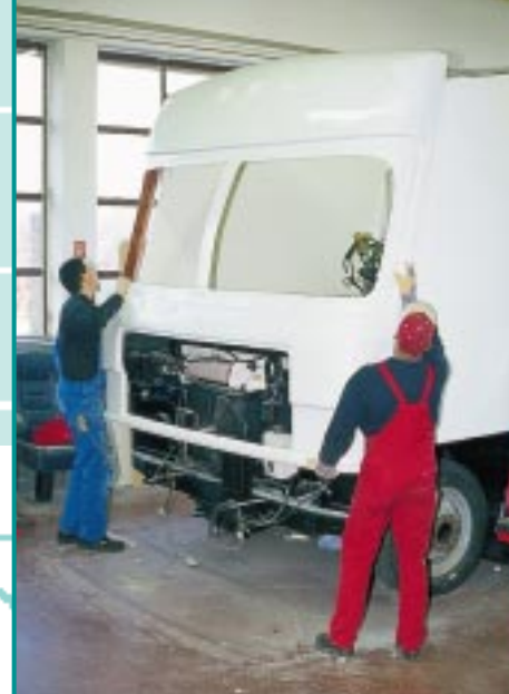
Feinarbeit: Die Elektroleitungen werden verlegt (ganz links) und die Front eingesetzt.
