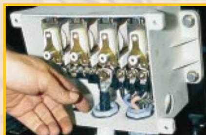
Verdrahtet: Platzierung der Relaisleiste im Sitzkasten. Montage des Schaltkastens, Verkabelung im Schaltkasten (von oben nach unten).
