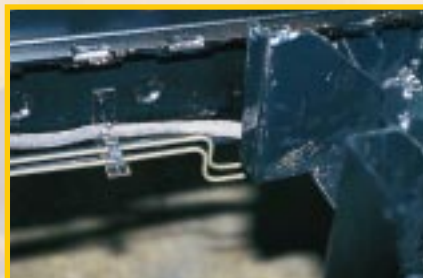
Geschaltet: Gebogene Bremsleitungen für Montage der Halterungen, Handschalter am Armaturenbrett, Fußschalter auf Bremspedal (von links nach rechts).
