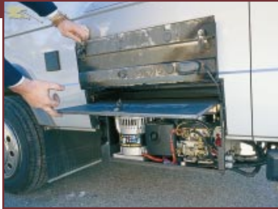
Ungewöhnlich: Der Stromgenerator ist in diesem Reisemobil als Festeinbau in einem Unterflur-Staukasten untergebracht (links). Die Schalttafeln für die Elektroanlage haben am Kleiderschrank ihren optimalen Platz (rechts).
