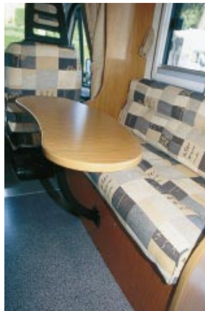
Schwenkbar: Der Zusatztisch (unten) sitzt auf einem bogenförmigen Fuß.
