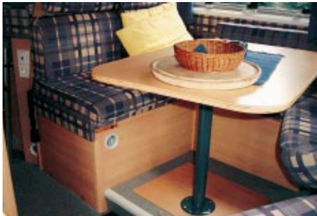
Fest: Sechs Schrauben halten den Tischfuß in der Bodenklappe.
