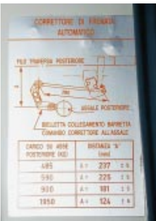
Ein Schild am Basisfahrzeug informiert über Abhängigkeit von Federweg und Achslast an der Hinterachse.
