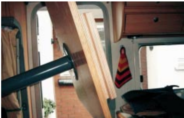
Geklemmt: Unter die Bodenklappe geschraubte Holzleisten greifen unter Gegenstücke im Boden.
