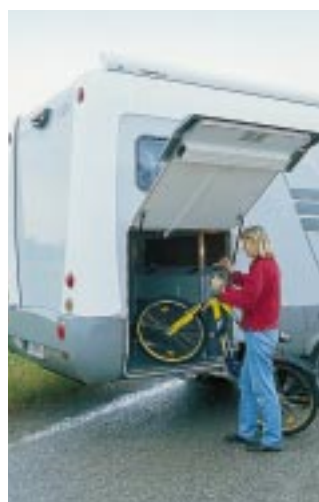
Solide: Die Tür der Heckklappe halten zwei Gasdruckstoßdämpfer offen.
