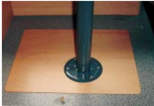
Fest: Sechs Schrauben halten den Tischfuß in der Bodenklappe.
