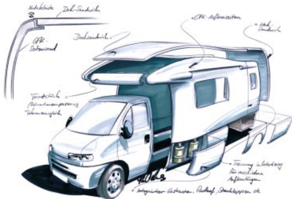
Tiefer Einblick: Eine Explosions-Skizze verdeutlicht den passgenauen Sitz der GfK-Formteile.
