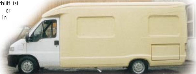
Moderne Ansichten: Das erste 1:1-Modell des neuen Teilintegrierten von Bürstner. Deutlich erkennbar sind die nahtlosen Wände und die integrierten Rahmen für Fenster, Tür und Klappen.
