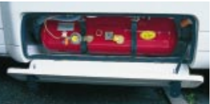
Die Klappen der Möbel sind perfekt eingepasst. Der 45 Liter fassende Gastank liegt gut geschützt im Außenstaufach.
